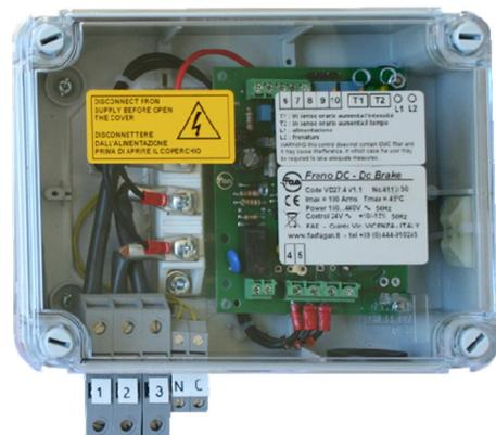
VD27-4 máxima potencia del motor 22kW(400Vca)/ 11kW(230Vca). Dimensiones 230Lx180hx140p
