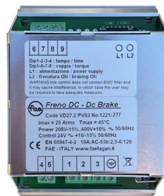
VD27-2 макс. мощность двигателя 7,5кВт(400Vac)/ 4кВт(230Vac). Размеры 85дл.х120выс.х80гл.
